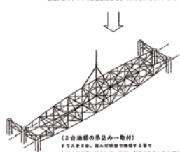
(2台地組を立てて地組) トラスを吊り、橋本で組立てた状態で吊り上げた後、現場で吊り込み、吊り込み後、現場で組立てる。
